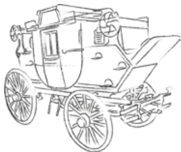
Steinkellerka – 12-osobowy, 4-kołowy, 2–4-konny omnibus produkowany w wytwórniach P.A. Steinkellera
